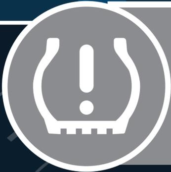
Una luz de advertencia de tu sistema TPMS que permanece encendida indica **baja presión de los neumáticos**. Revisa la presión de los neumáticos e infla según sea necesario. Si una llanta está desinflada o se empieza a desinflar, cámbiala inmediatamente, **¡no conduzcas con ella!**
