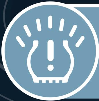
Una luz de advertencia de tu sistema TPMS que parpadea de 60 a 90 segundos y luego permanece encendida indica un mal funcionamiento del sistema. **Busca servicio profesional.**
